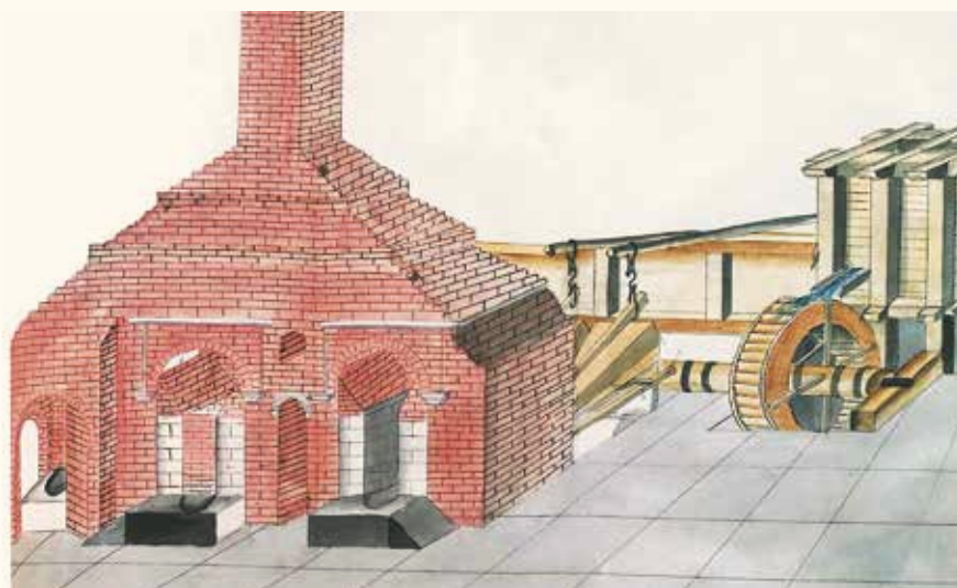
Медеплавильная печь. Рисунок из книги В. И. Геннина «Описание Уральских и Сибирских заводов»
